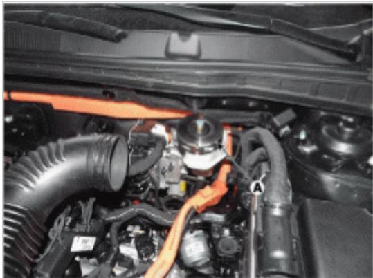
6. 确认空气切断阀(A)关闭，并将专用工具(09580-3D100)(A)连接到盖(B)上。
